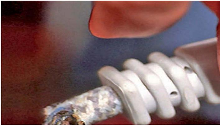
Elektrische Geräte, inklusive der Leitungen, sollten sich in einwandfreiem Zustand befinden. Bei derartigen Rissen sollte unbedingt für Ersatz gesorgt werden. FOTO: DJD/WWW.BGETEM.DE/THX
